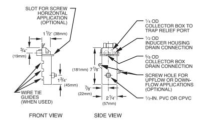
Fig. 4—Condensate Trap
